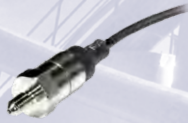
Мініатюрний датчик тиску з вбудованою електронікою Надійна конструкція повністю з нержавіючої сталі Конструкція, що витримує жорсткі умови навколишнього середовища та занурення в масло (приспосована з автоматичною коробкою передач) Робота від -40 до +150^\circ\text{C} Смуга пропускання 3 кГц
